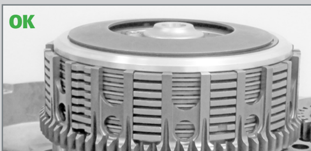
Detailansicht der korrekten Montage der Tellerfeder.
