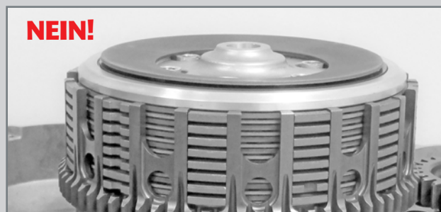
Detailansicht der falschen Montage der Tellerfeder.
