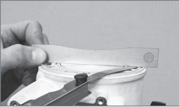
Fall, indem der Kolben das Plättchen drückt und der Kontakt Zylinder Plättchen sich verringert
