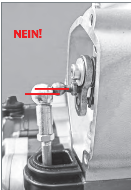
Falsche Stellung des Sitzes der Steuerstange.
