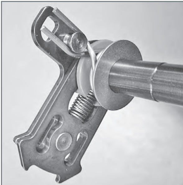
Schaltwelle; die Positionierung der Rückholfeder der Schaltsteuerung beachten.
